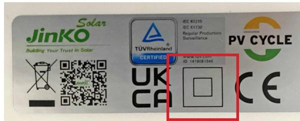
Bei SK-II Geräten handelt es sich um elektrische Betriebsmittel mit verstärkter Isolierung bei denen die Isolation zwischen dem Stromkreis und dem Gehäuse so gut ist, dass keine Gefahr von den spannungsführenden Teilen ausgeht. Gemäß VDE 0100 bzw. IEC 60364 ist in diesen Fällen die Erdung mittels Schutzleiter aus Personenschutzgründen ausgeschlossen.
