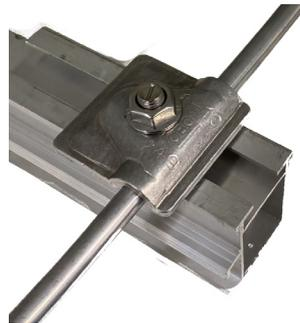
Beim Systemträger ST-AK 5 40, welcher lediglich einen seitlichen Hammerkopfkanaal besitzt, kann die Potentialausgleichsklemme direkt auf die Oberseite des Aluminiumprofils mittels Dünnschraube montiert werden (siehe Abbildung unten). Das selbe gilt auch für die S:FLEX Trapezblechschiene AK.
